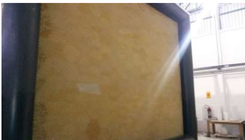
Figura 7.2. Colmeia para estabilização do escoamento Fonte: autoria própria
