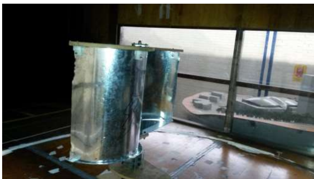
Figura 7.6. Rotor instalado no túnel para ensaio Fonte: autoria própria
