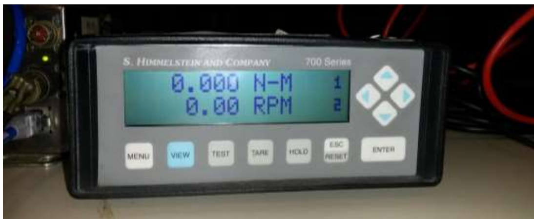
Figura 7.8. Equipamento de leitura do torquímetro Fonte: autoria própria
