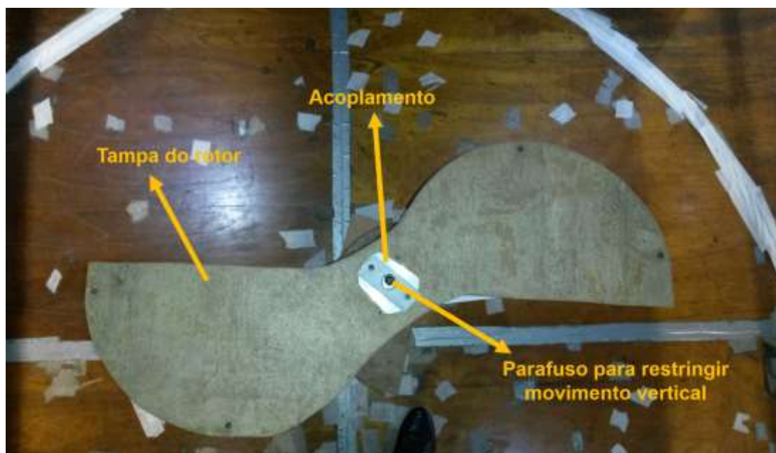
Figura 7.5. Tampa do rotor fabricada em MDF Fonte: autoria própria
